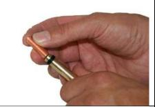
Insert weld stud into stud chuck.
